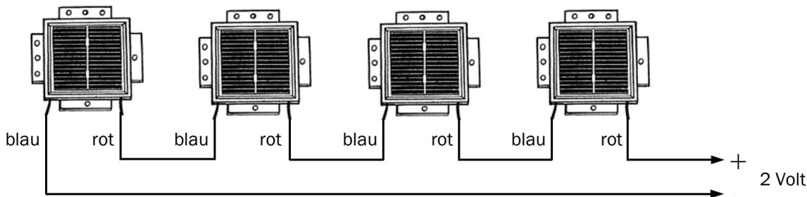
**D** Durch Serienschaltung der einzelnen Solarzellen können Solarkollektoren mit höheren Spannungen zusammengeschaltet werden. Die Spannung addiert sich dann: z.B. ergeben 6 Solarzellen in Serie geschaltet eine Ausgangs-Nennspannung von ca. 3V (6 x 0,5V).
